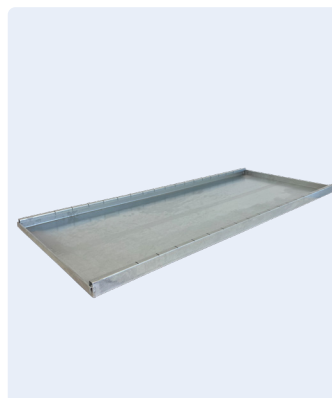
Varenr. 431V0105-100 Galvaniseret hylde for KS-1 og KS-0.5 forberedt for skilleplader Udv. mål i mm.: H:30 B:995 D:405
